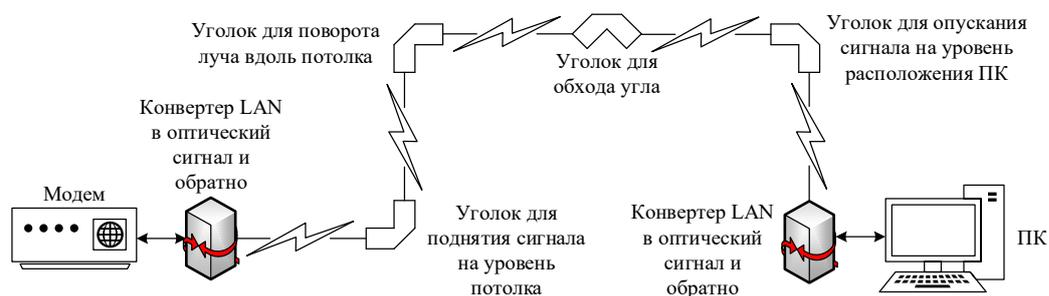
Рисунок 3 – Схема сети точка-точка с использованием оптического излучения
