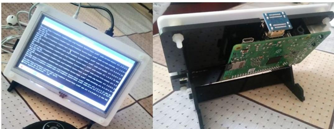
Рисунок 4 – Внешний вид планшетника на микрокомпьютере Raspberry Pi
