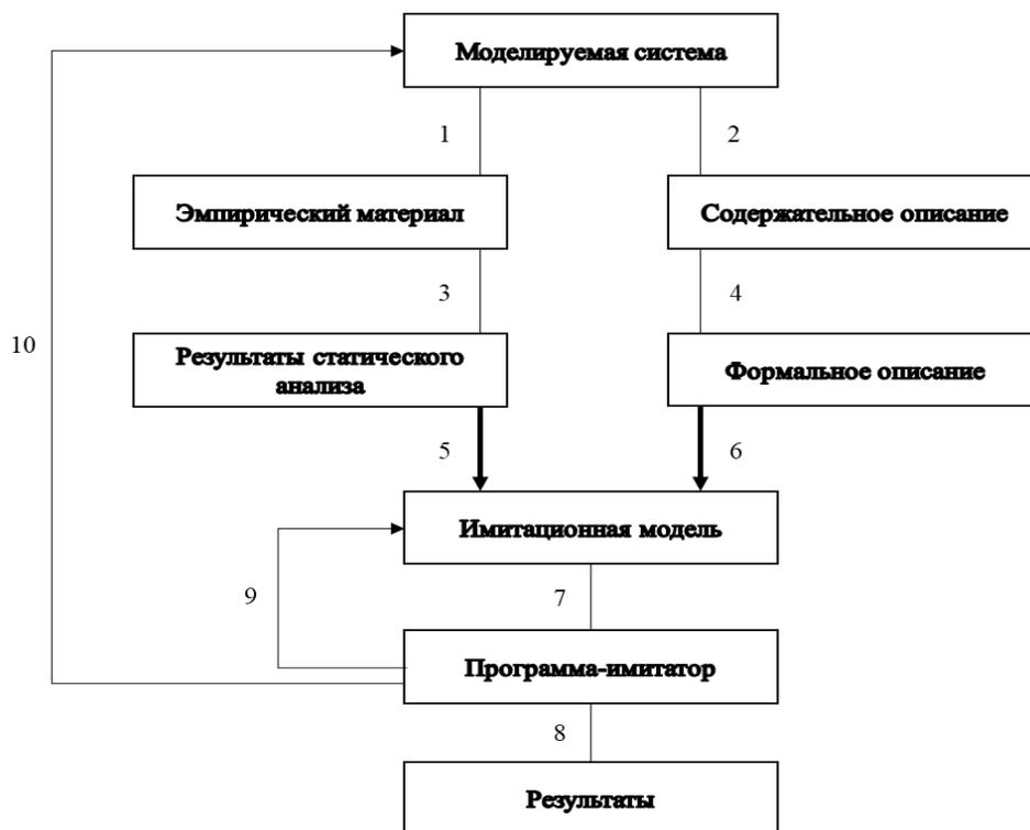
Рисунок 1 – Процесс создания имитационной модели
