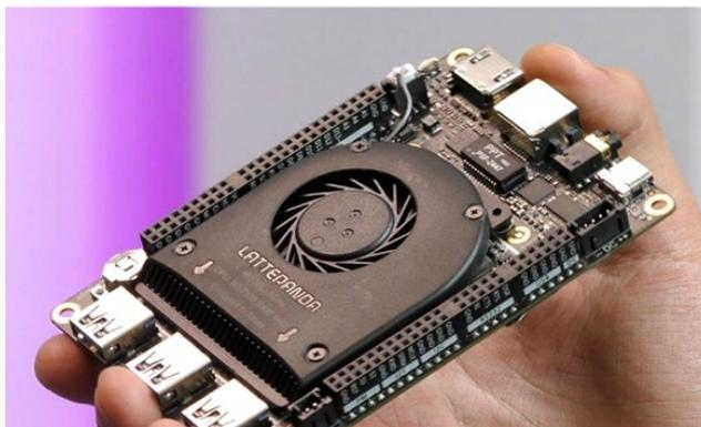
Рисунок 2 – Микрокомпьютер LattePanda Alpha 864s
