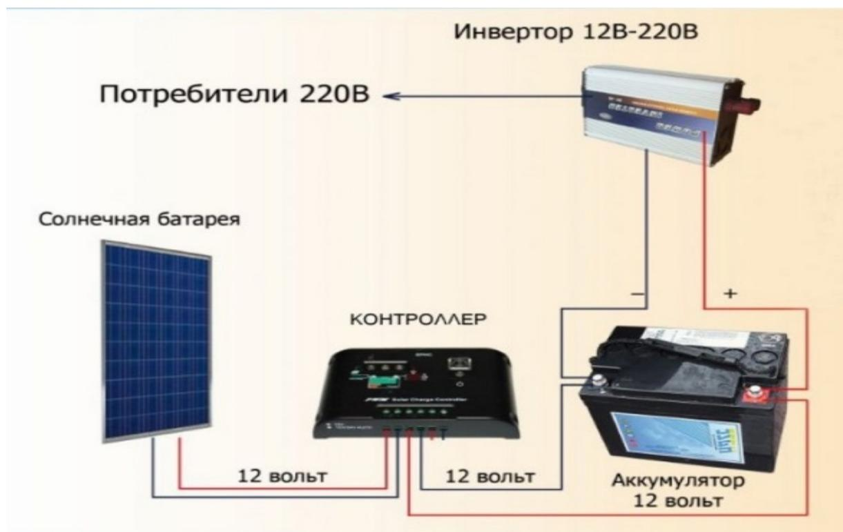
Рисунок 3 - Структурная схема солнечной батареи
